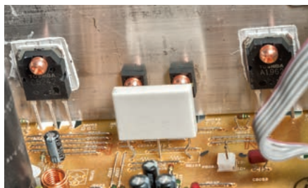
Pioneer, podobnie jak Yamaha, stosuje tranzystory wyjściowe Toshiba, po jednej parze na kanał.
